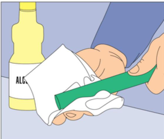
**3-** Antes de efectuar una termofusión el instalador debe verificar que tubo y accesorio se encuentran limpios y en condiciones de ser fusionados. De la misma manera a lo indicado en la ilustración 1, la limpieza debe realizarse con trapo limpio de algodón o papel tissue embebido en alcohol etílico. Recomendamos no usar ningún otro líquido limpiador.
